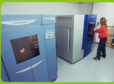
2台並んだ造形機。最大で600×600×600mmの造形を行うことができる
